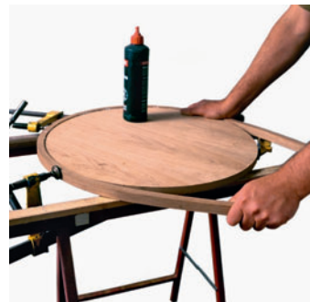
/ Biegbares Holz eignet sich besonders für Anleimer bei runden Teilen.
