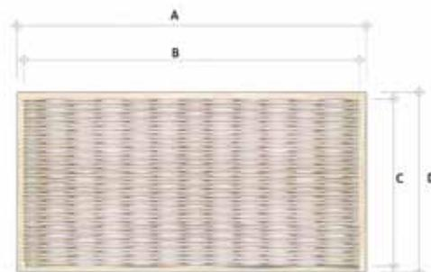
**Die Fräsung** erfolgt immer der Länge und der Holzrichtung nach. Jede Platte hat aus Transportgründen rundum einen ungefrästen Rand.
