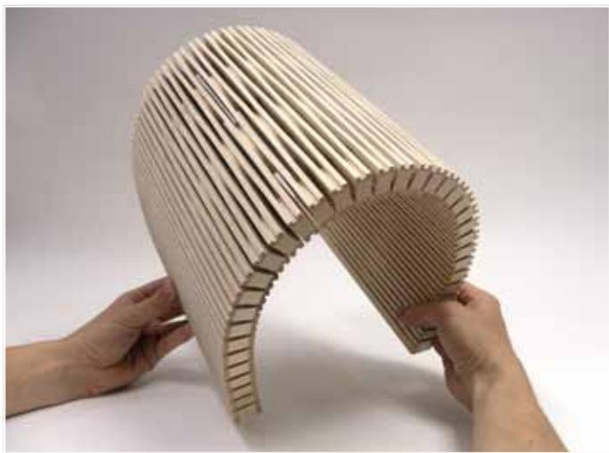
Der Biegeradius ist abhängig von der Frästyp, dem Material und der Plattenstärke.
