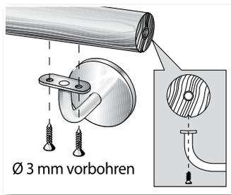
Handlaufstütze mit Auflage in der **Nut** des Handlaufs verschrauben. (Senkkopfschraube 3,5x25 mm).
