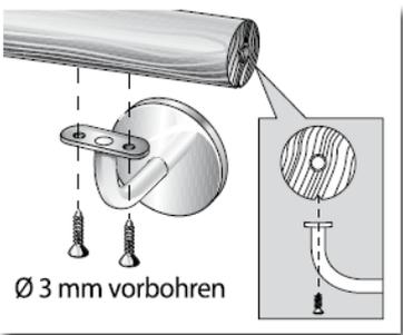
Handlaufstütze mit Auflage in der **Nut** des Handlaufs verschrauben. (Senkkopfschraube 3,5x25 mm).
