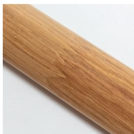
Keilgezinkt bedeutet, dass zwei Vollholzteile durch keilförmige Zinken ineinander greifen und mittels Leim verklebt sind. Dadurch entsteht eine stabile und nahezu verzugsfreie Verbindung zwischen kürzeren Holzstücken zu einem langen Holzstück. Keilgezinkte Handläufe sind ein nachhaltigeres und ressourcenschonenderes Produkt. Bei der Herstellung können auch kürzere Holzstücke verwendet werden und damit wird möglichst viel vom Baum verarbeitet.
