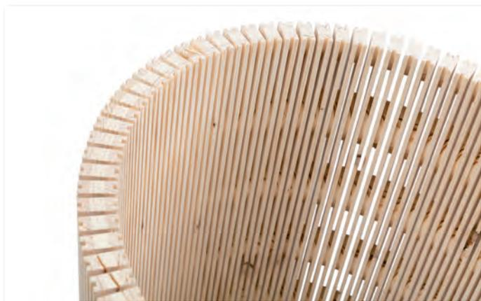
Der Biegeradius ist abhängig von der Frästypen, dem Material und der Plattenstärke.
