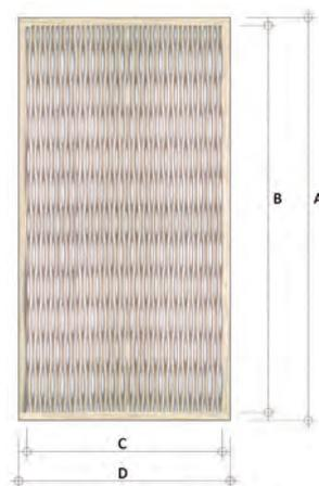
Die **Fräsung** erfolgt immer der Länge und der Holzrichtung nach. Jede Platte hat aus Transportgründen rundum einen ungefrästen Rand. Die **Oberfläche** der Platte ist immer roh.
