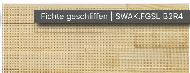
Die Paneele von STEPWOOD® Akustik haben eine Größe von L 1250 x B 219 mm und sind rundum genietet. Die Oberfläche ist immer geschliffen und lackiert. Rückseite mit Akustikvlies schwarz. Der Absorptionswert wird durch die Aufbauhöhe und das Dämmmaterial mitbestimmt. Alle weiteren technischen Details siehe Seite 22.
