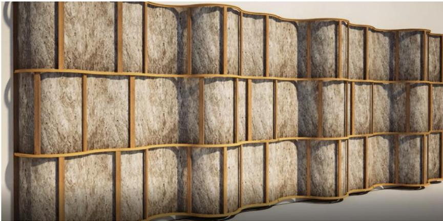
Befestigen Sie die biegsame Metalleiste DU.ML40 mittels Schrauben an die mittleren Bogenelemente. Idealer Schraubendurchmesser: 3,5mm
